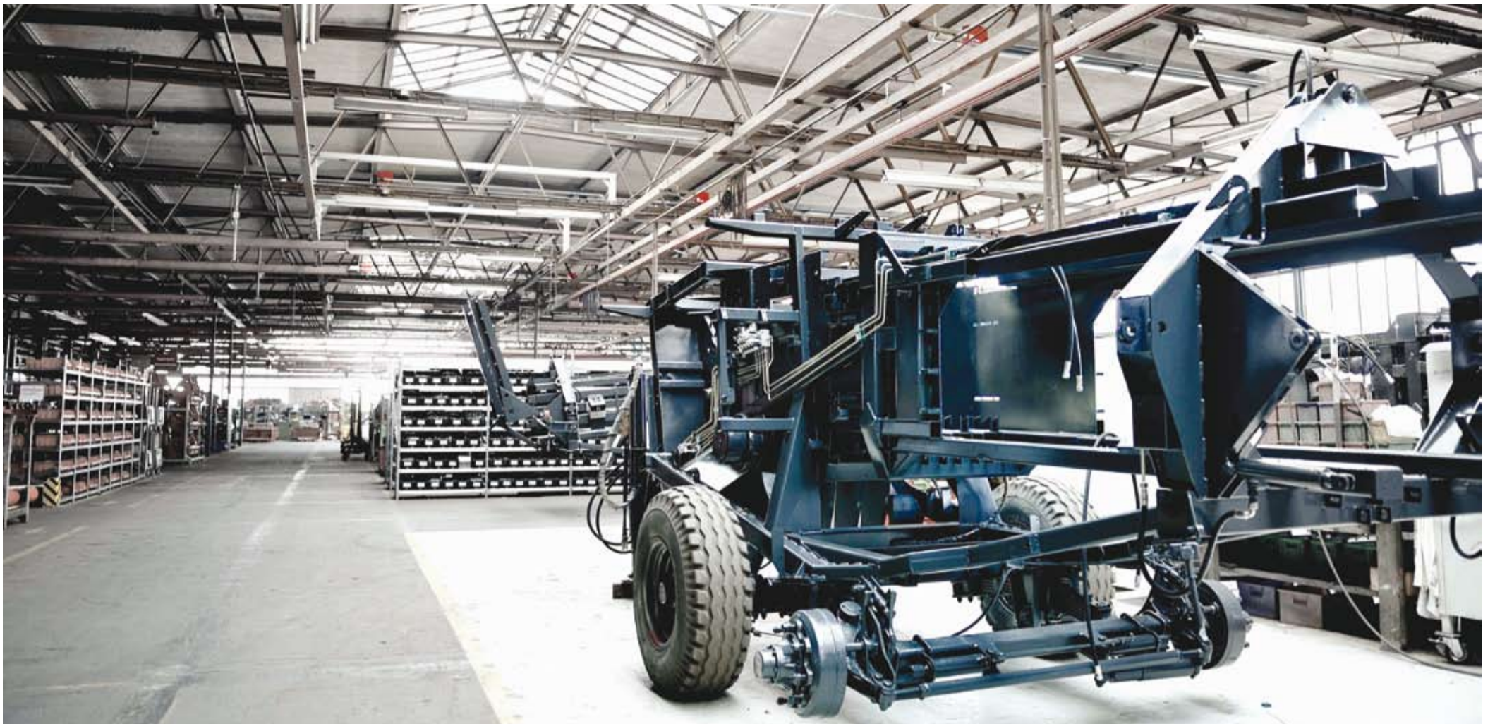
Umwelt-Contracting, neuester Stand: Seit die Fertigungshallen des Landmaschinenbauers Welger nicht mehr mit einer dampfbetriebenen Warmluftheizung, sondern mit Hell- und Dunkelstrahlern beheizt werden, verbraucht das Unternehmen 40 Prozent weniger Energie.
